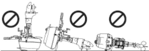
Не кладите мотор в вертикальное положение прежде, чем полностью высохнет система охлаждения. Вода может попасть в цилиндр, что приведет к сбоям в работе мотора.
