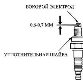
Измерьте зазор свечи с помощью круглого щупа. Зазор должен быть 0,6-0,7 мм. Установите нужный зазор подгибанием бокового электрода. Вверните свечу зажигания до упора. Дотяните свечным ключом для уплотнения шайбы: старую свечу на  $\frac{1}{4}$  оборота, новую свечу на  $\frac{1}{2}$  оборота. Свободно установленная свеча зажигания перегревает и портит двигатель. Сильно затянутая свечка зажигания может повредить резьбу крышки цилиндра. Наденьте колпачок на свечу.
